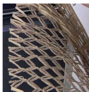
Trasforma il cartone usato in materiale flessibile per imballaggio.
