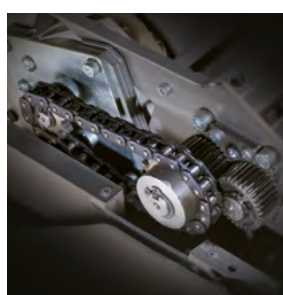
Trasmissione a catena con ingranaggi in acciaio.
